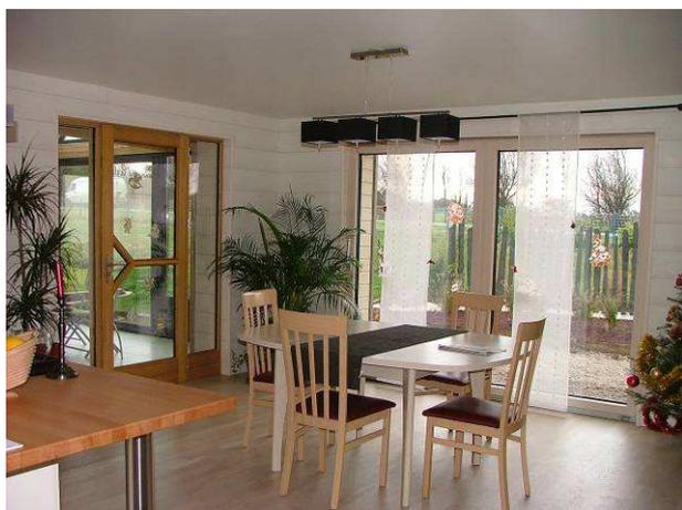
Toutes les ouvertures, hormis celles de la véranda, disposent d'un triple vitrage. Les menuiseries sont mixtes : aluminium à l'extérieur et bois à l'intérieur.
