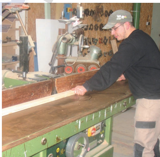
L'entreprise dispose d'un équipement complet au sein de son atelier bois, dont cette scie à format Sicar et cette toupie Griggio.
